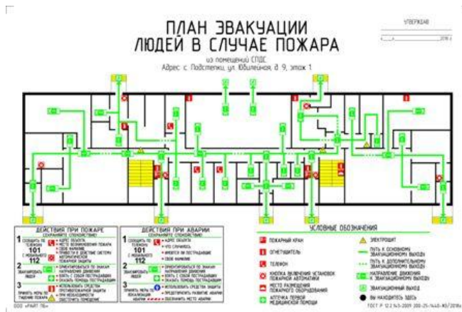
Фото № 15 План эвакуации 1 этажа
